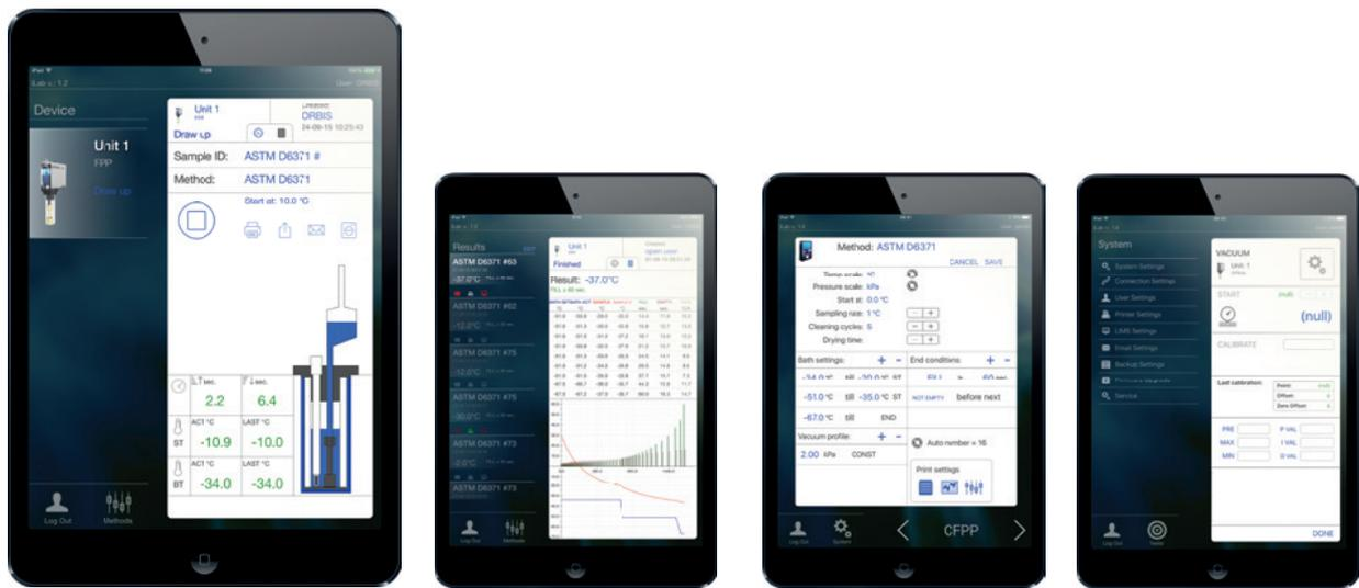
O aplicativo de software AirSTAR CFPP é projetado para um controle fácil e flexível. Ele oferece várias opções para gravação e exibição de dados e muitas opções para personalizar programas. Os resultados dos testes e a animação do progresso são exibidos em tempo real.
