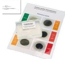
Este teste utiliza um método comparativo: uma gota de óleo a ser testado é derramada sobre um papel de filtro sobre o qual se espalha e forma uma mancha a ser comparada no gráfico.
