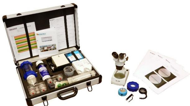
O teste é realizado com aparelho POLLUVISION™ que permite filtrar o fluido e capturar os poluentes em uma membrana calibrada.
