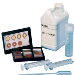
Este teste utiliza um método de reação: uma solução é adicionada ao óleo a ser testado que irá capturar qualquer possível cloreto no óleo.
