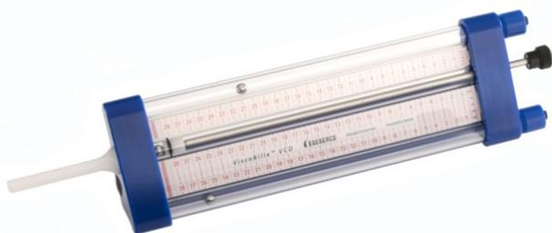
O Viscobille™ VCD da GESERCO é uma ferramenta altamente sensível e precisa para comparação cruzada da viscosidade de 1 líquido testado com as viscosidades de 2 líquidos de referência que podem definir, por exemplo, a viscosidade mínima e máxima aceitável para o líquido testado.
